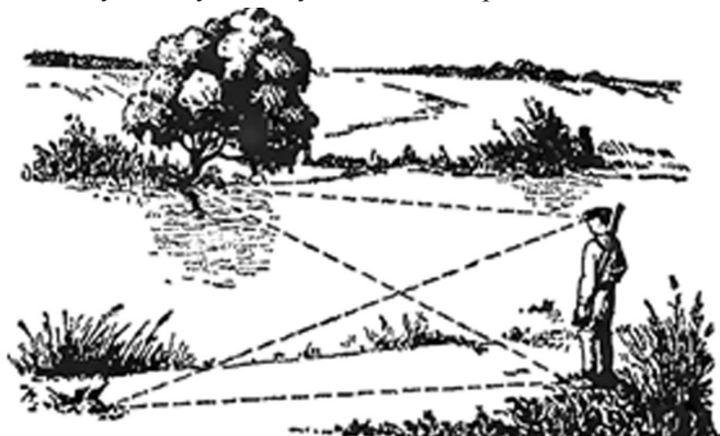
Рис.1. Задача на измерение ширины реки с помощью козырька
